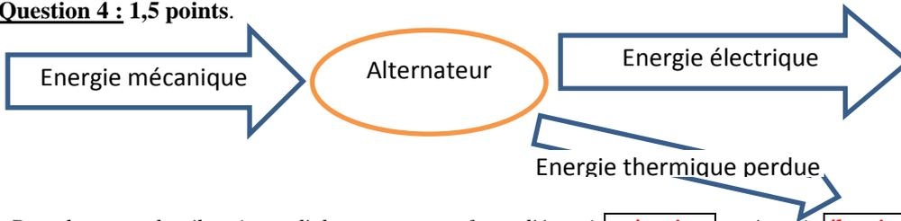
Dans les centrales électriques, l'alternateur transforme l'énergie **mécanique** en énergie **électrique**.
