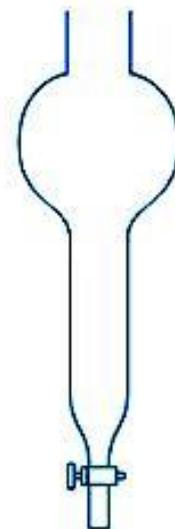
Ampoule à décanter
