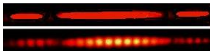
a. Figure de diffraction avec une seule fente. b. Interférences obtenues avec 2 fentes d'Young).
